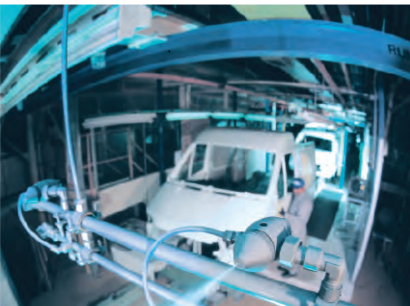
Befeuchten in einer Autolackieranlage
